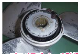
プロペラブッシュの破損
